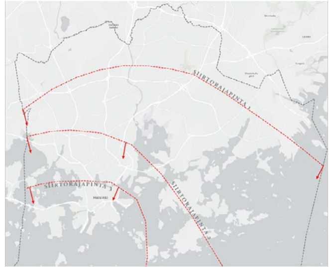
Kuva 19. Helsingin 110 kV verkon siirtorajapinnat
